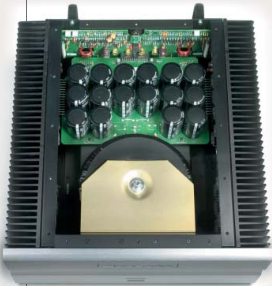
Ordinato e ben ingegnerizzato l'interno presenta un possente trasformatore da 2000 VA e 16 elettrolitici da 10.000 \mu F.
